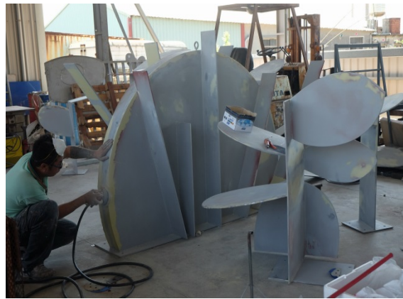
防鏽處理（二道底漆工程）
