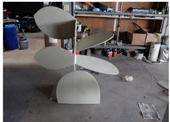
防鏽處理（二道底漆工程）
