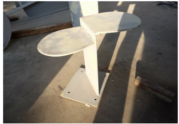
防鏽處理（二道底漆工程）
