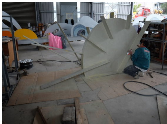
防鏽處理（二道底漆工程）
